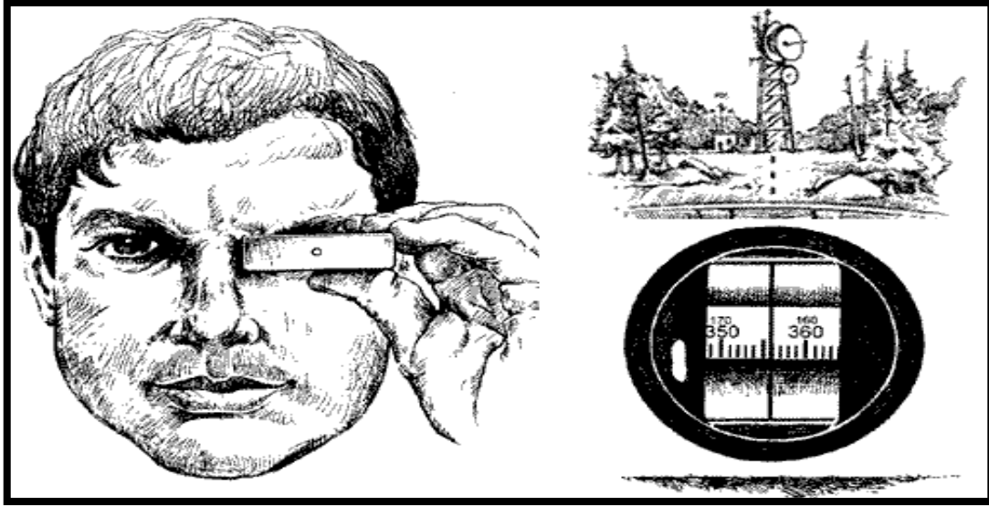
Şekil-12. Pusulanın tutuş şekli ve ölçüm yapılırken pusulanın içinde okunacak olan değerin görünümü
