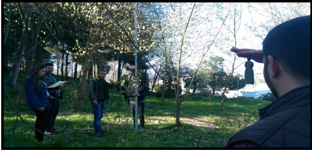
Fotoğraf-3. Klizimetre ve Mira yardımıyla yükseklik farklarının bulunması
