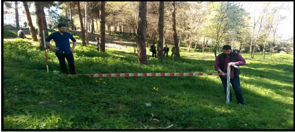
Fotoğraf-4. Lata yardımıyla yol geçkisinin yardımcı noktalarının bulunması
